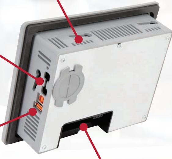
Ports Ethernet intégrés simples ou DLR pour la connectivité sur les terminaux Standard et port Ethernet intégré avec DLR sur les terminaux Performance
