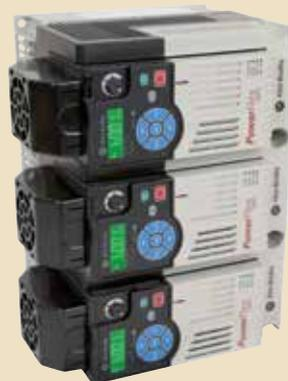
Pour plus de flexibilité, les trois variateurs peuvent être installés verticalement ou horizontalement, ainsi que côte à côte dans n'importe quelle orientation. Un kit ventilateur pour module de commande est nécessaire pour le montage horizontal.
