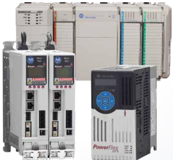
*Pour les applications qui nécessitent à la fois une régulation de vitesse simple et des fonctionnalités moteur précises, une combinaison de variateurs c.a. et de servovariateurs est la solution logique. Le variateur c.a. PowerFlex 527 gère la régulation de vitesse simple et un servovariateur Kinetix gère les opérations de commande de moteur plus précises concernant la régulation de vitesse, de couple et de position.*
