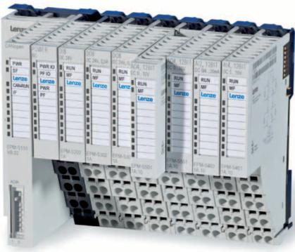
Au premier coup d'œil, ces modules E/S 1000 se distinguent par leur conception compacte pouvant comporter jusqu'à 8 bornes de raccordement. Mesurant seulement 12,5 mm de large, ces modules extrêmement fins s'installent facilement sur un rail profilé classique.
