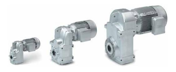
Nos réducteurs compacts à arbres parallèles se caractérisent par des forces radiales admissibles élevées, des rapports de réduction finement échelonnés et un jeu angulaire faible. Ils sont disponibles en version à deux ou trois étages avec un couple pouvant aller jusqu'à 19 000 Nm et, selon vos besoins, avec des rapports de réduction jusqu'à i=500.
