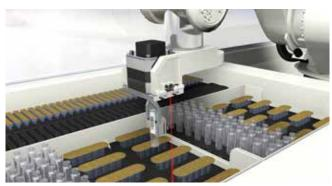
Robotique – contrôle de présence dans les préhenseurs Grâce à leur faible poids et leur compacité, les détecteurs miniatures O 200 permettent l'agilité nécessaire des pinces.
