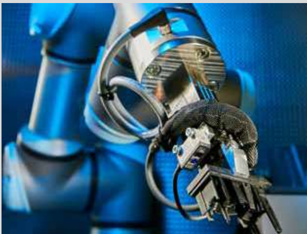
Mesure de la distance dans des applications robot, directement embarqué sur le bras du robot
